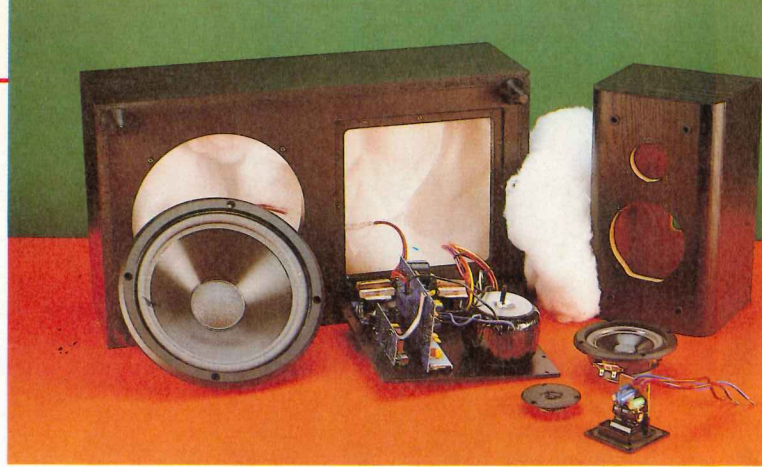
Sia il mobile del piccolo satellite RS 1001 che del grosso subwoofer sono in truciolare e danno l'impressione di notevole robustezza. I due diffusori sono entrambi casse chiuse, ed il loro interno è riempito con una notevole quantità di assorbente acrilico.
